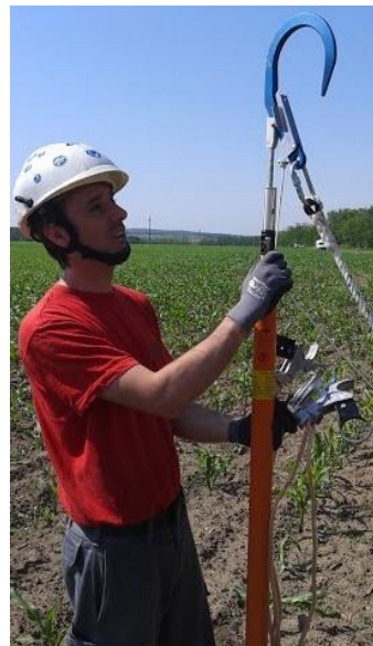
22.-23. Vezető kötélnél zuhanás gátlóval, kezelőrúddal
