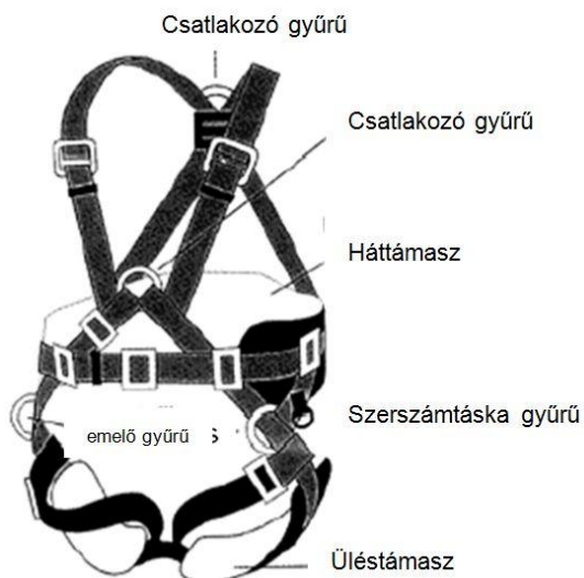
11. Testheveder felépítése
